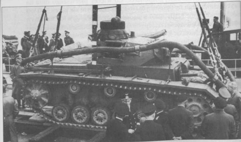
Czołg PzKpfw 111 Tauchpanzer ; widoczne rury doprowadzające powietrze dla silnika i załogi
