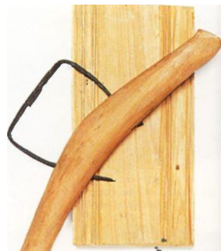
Żelazne narzędzie do wycinania rowków i wzorów na desce
