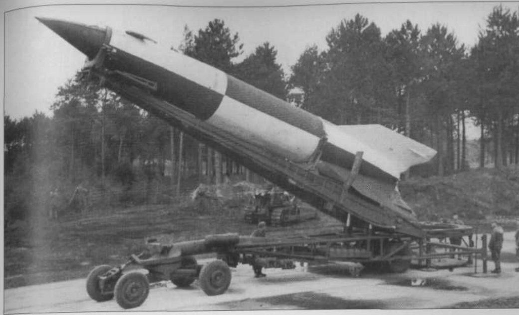
V2 ustawiany w pozycji startowej przez Meillerwagen. Na miejscu znajdują się już podstawa rakiety oraz „wyciskacz do cytryn”, deflektor gazów wylotowych. Brytyjskie odpalenia V2, Cuxhaven, październik 1945 roku (Imperial War Museum w Duxford)
