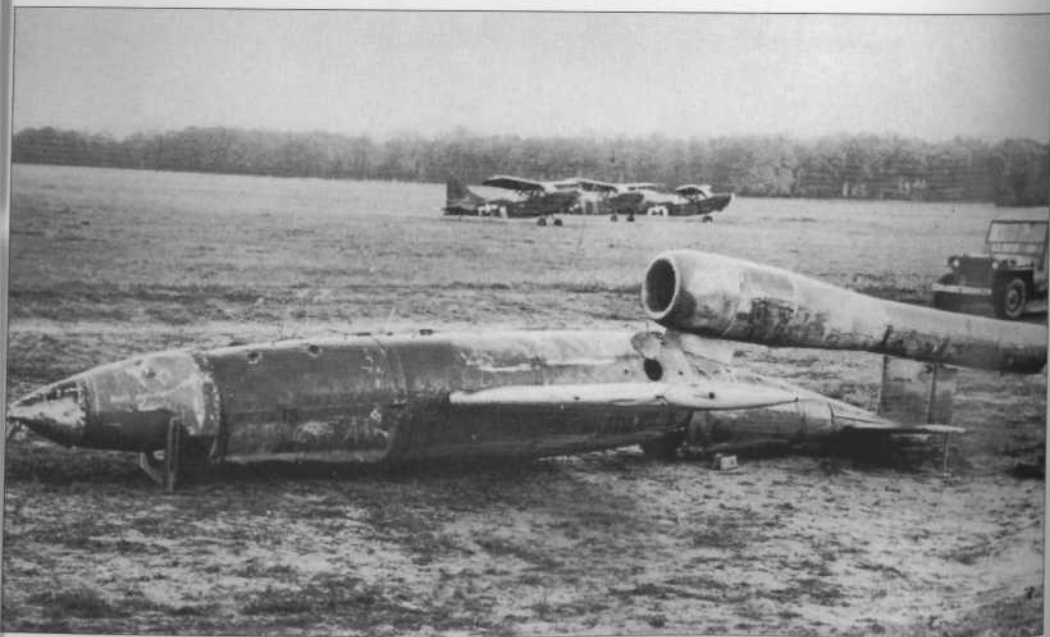
VI po awarii silnika stmmieniowego; północna Francja, 1944 wk. Niewielkie uszkodzenia potwierdzają, że VI charakteryzował się stabilnym lotem (Imperial War Museum w Duxford)
