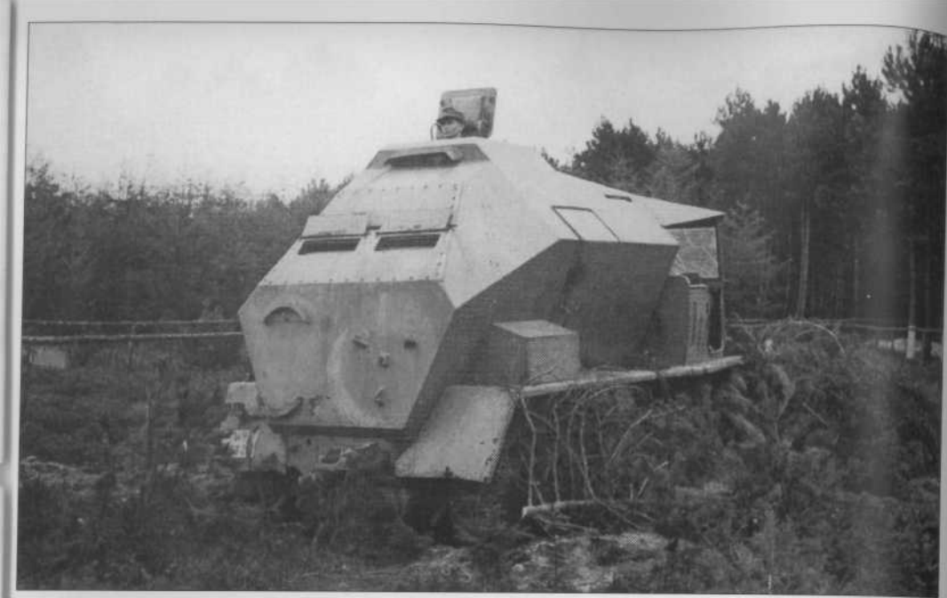
Pojazd dowodzenia startem V2 dla stanowisk polowych. Gdy stanowisko było często używane, specjalny transporter opancerzony na podwoziu 3-tonowego Hanomaga parkowano w garażu „prostego stanowiska” (Imperial War Museum w Duxford)
