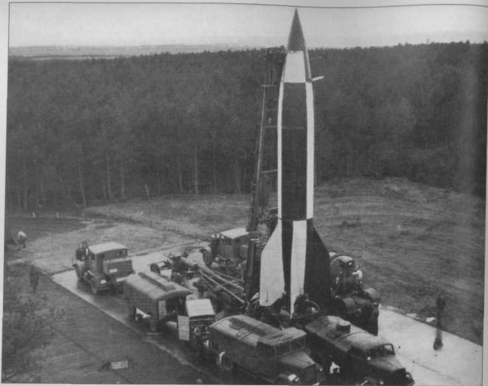
Napetnianie V2 materiałami pędnymi przed operacją Backfire (brytyjskie odpalenia V2, Cuxhaven, październik 1945 roku) (Imperial War Museum w Duxford)
