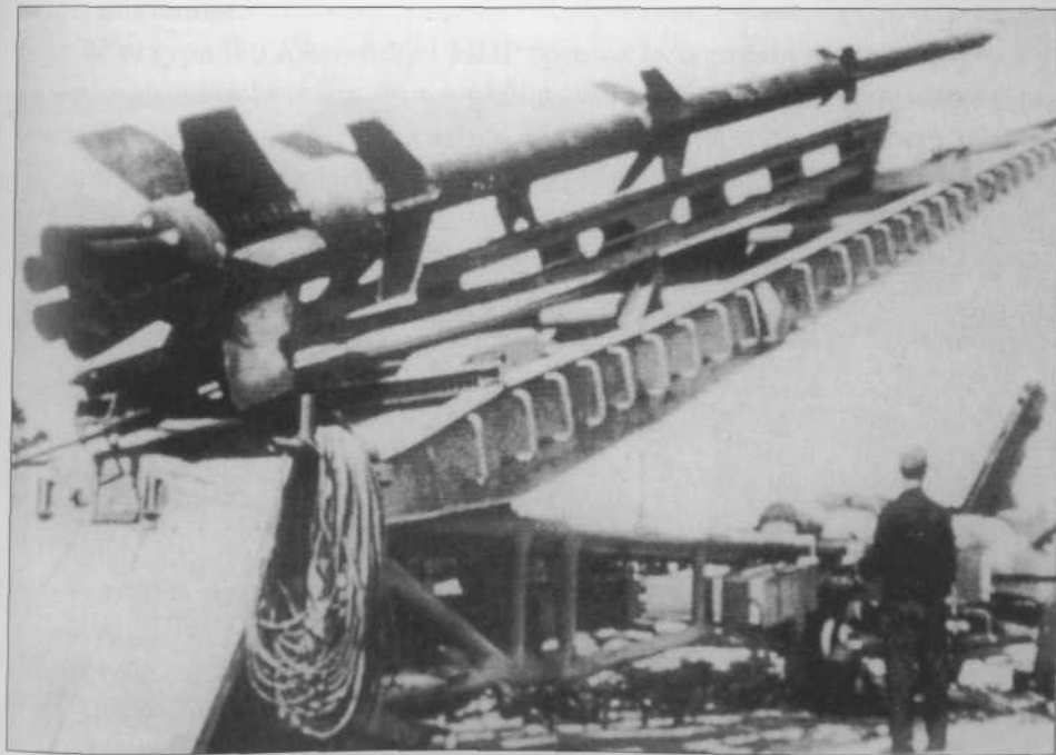
Rheinbóte - zmontowana raketa na przerobionym Meillerwagenie V2, ustawiona przed odpaleniem pod właściwym kątem. Nawet przy zastosowaniu dodatkowych wsporników ten załpymwizowany sprzęt nie zapewniał stabilnej podstawy dla rakiety mającej 13,5 metra długości. Specjalistyczny sprzęt startowy został zaprojektowany, ale go nie wyprodukowano (BA, Freiburg)
