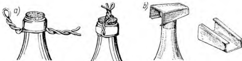
Rys. 27. Zabezpieczenie korka: a) obwiązywanie węzłem aptekarskim, b) zabezpieczenie kłamarą
