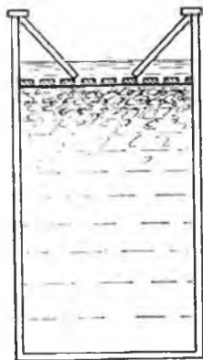
Rys. 61. Fermentacja w miadze w naczyniu drewnianym z kratą
