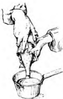
Rys. 29. Zanurzanie szyjki butelki w szczeliwie
