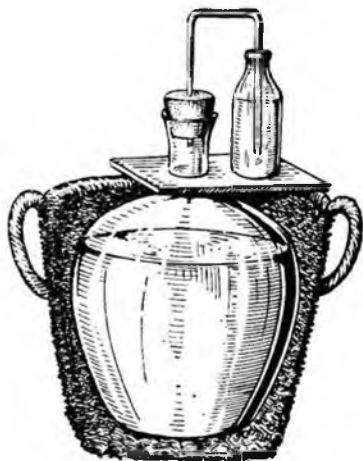
Rys. 62. Balon w koszu z najprostszym czopem fermentacyjnym
