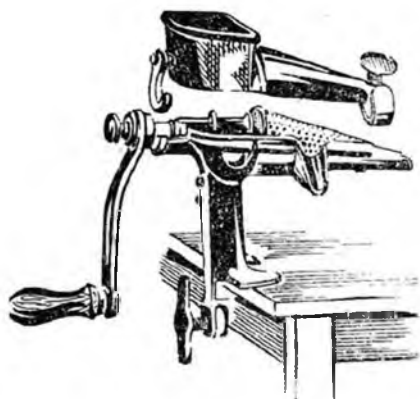
Rys. 9. Ślimakowa przecieraczka „Tutti-frutti” (z podniesioną górną częścią)
