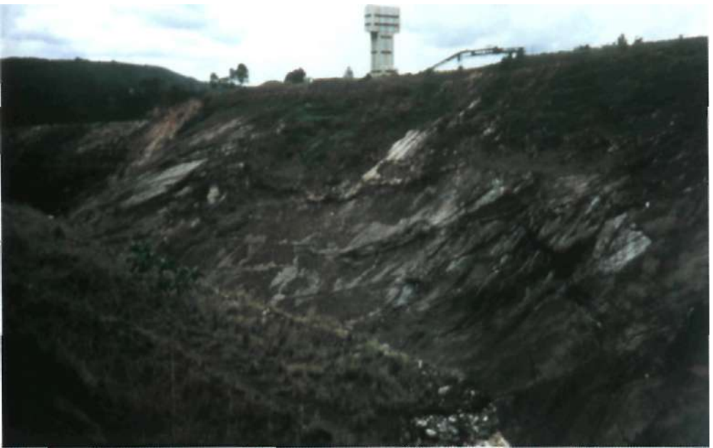
1. Kopalnia uranu w Oklo. Na pierwszym planie widać wyrobisko powstałe wskutek odkrywkowej eksploatacji, dalej - wieżę szybową kopalni. W 1988 roku kopalnię zalano.
