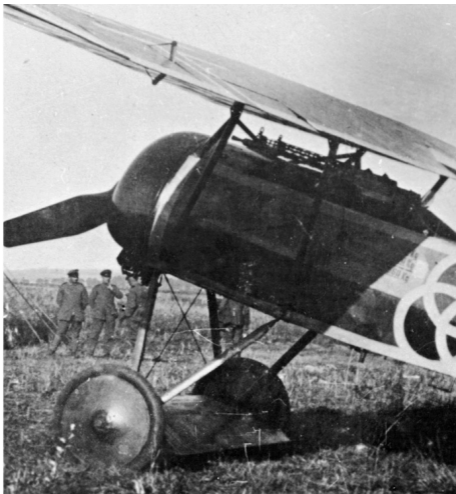
Fokker D-VII wyposażony w podwójne karabiny maszynowe Spandau. Na kadłubie widoczne trzyna chodzące na siebie koła marki Krupp, głównego niemieckiego producenta uzbrojenia w czasie wojny
