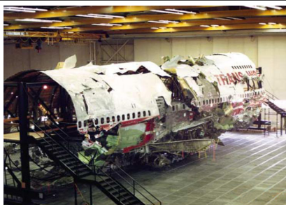
Rekonstrukcja kadłuba Boeinga, który uległ katastrofie.
