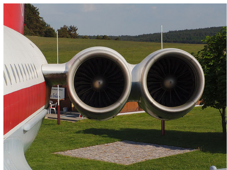
Zespół silników samolotu Il-62 – nr 1 (silnik zewnętrzny) i nr 2 (silnik przy kadłubie)
