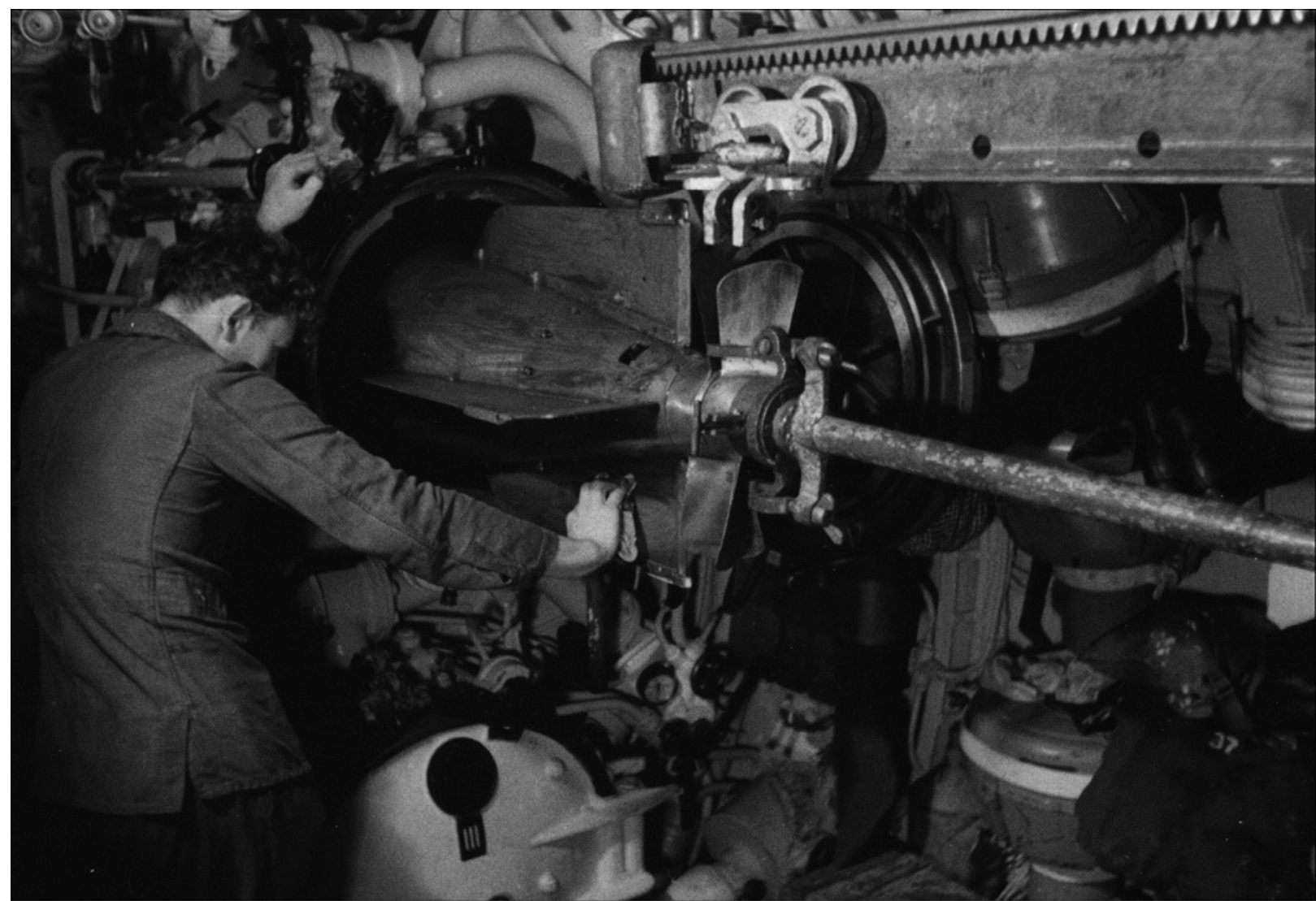
Załadunek torped do wyrzutni w dziobowym przedziale torpedowym okrętu U-103 .
