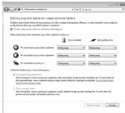
Rysunek 4.68. Te ustawienia dotyczą wszystkich planów zasilania. Aby zastosować je wyłącznie dla wybranego planu, należy użyć jego okna dialogowego Ustawienia zaawansowane (zobacz rysunek 4.67)
