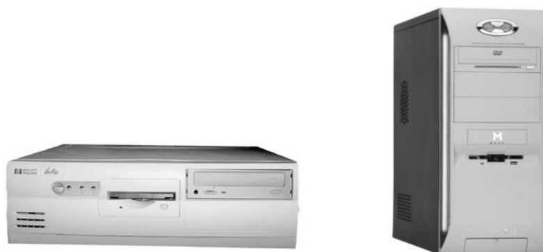
Rysunek 1.1.3. Typowe obudowy komputerowe desktop i tower
