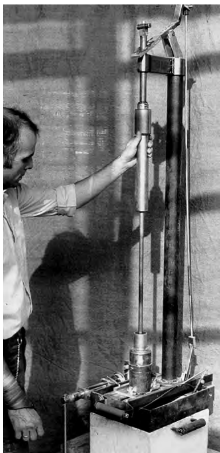
3.5-2 URZĄDZENIE DO ZAGĘSZCZANIA PRÓBEK GLINY, LABORATORIUM BUDOWNICTWA EKSPERYMENTALNEGO (FEB)
