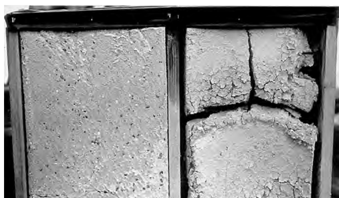
2.3-14 PRÓBKİ TYNKU GLINIANEGO PRZED (Z LEWEJ) I PO (Z PRAWEJ) TRZYLETNIM WPŁYWIE WARUNKÓW ATMOSFERYCZNYCH
