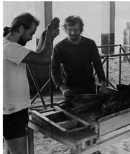
6.4-6 PRODUKCJA „WRZUCANYCH” CEGIEŁ GLINIANYCH NA STOLE
