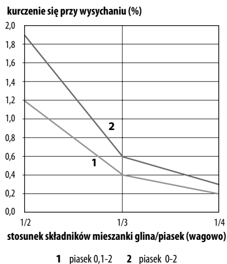
3.2-2 REDUKCJA SKURCZU SCHNIĘCIA GLINY PYLASTEJ POPRZEC DODAWANIE PIASKU
