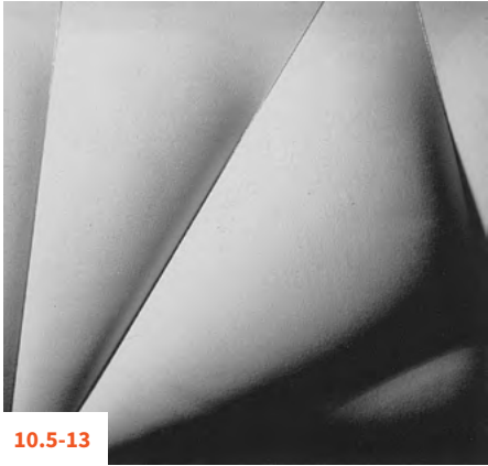
10.5-12 | 10.5-13 MODELE ŚCIAN POKOJU Z GLINY Z DODATKAMI MINERALNYMI WYKONANE W TEKSTYLNYM, TRACONYM SZALUNKU
