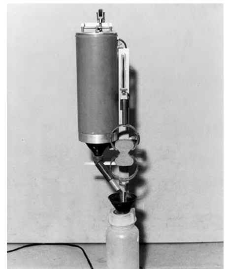
2.6-2 PRZYRZĄD KONTROLNY DO WYZNACZANIA SIŁY WIĄZANIA, FEB
