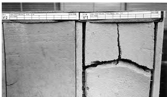
2.3-14 PRÓBKİ TYNKU GLINIANEGO PRZED (Z LEWEJ) I PO (Z PRAWEJ) TRZYLETNIM WPŁYWIE WARUNKÓW ATMOSFERYCZNYCH
