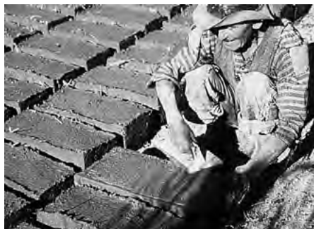
6.4-2 – 6.4-4 PRODUKCJA FORMOWANYCH RĘCZNIE CEGIEŁ Z GLINY W EKWADORZE
