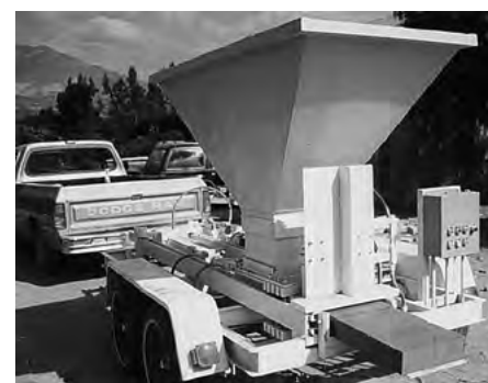
6.4-11 PRASA AUTOMATYCZNA DO PRODUKCJI CEGIEŁ GLINIANYCH, PACIFIC ADOBE, USA
