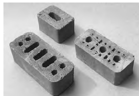
6.11-2 AKUSTYCZNE CEGŁY GLINIANE CHARAKTERYZUJĄCE SIĘ EFEKTEM ROZPROSZENIA DŹWIĘKU
