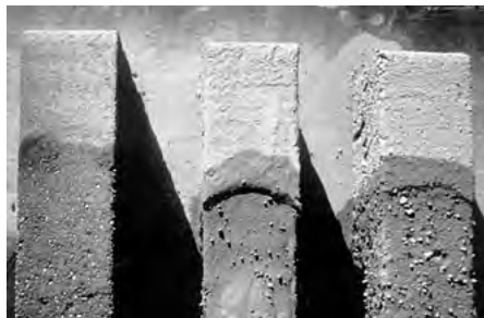
3.3-1 TEST NA ROZMYWANIE CEGIEŁ ZIELONEK
