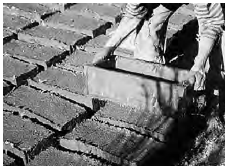
6.4-2 – 6.4-4 PRODUKCJA FORMOWANYCH RĘCZNIE CEGIEŁ Z GLINY W EKWADORZE
