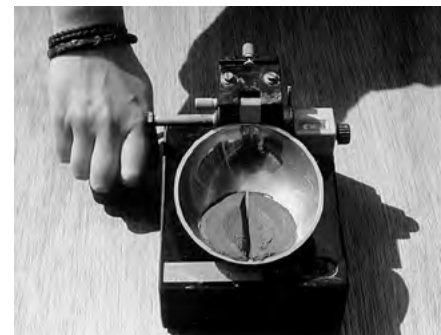
2.3-4 APARAT DO WYZNACZANIA GRANICY PŁYNNOCI WG CASAGRANDE
