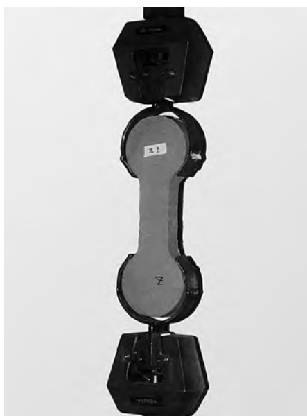
2.6-5 SPRAWDZANIE WYTRZYMAŁOŚCI GLINY NA ROZCIĄGANIE W STANIE WYSCHNIĘTYM
