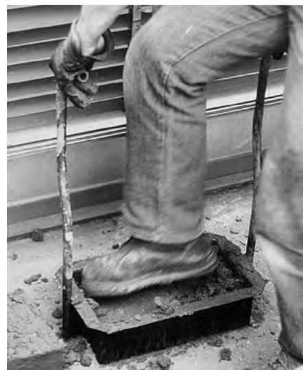
6.4-7 FORMA METALOWA Z UCHWYTAMI DO PRODUKCJI CEGIEŁ GLINIANYCH
