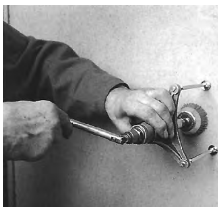
2.6-7 ZBUDOWANE W FEB URZĄDZENIA DO MIERZENIA WYTRZYMAŁOŚCI NA ŚCIERANIE POWIERZCHNI GLINIANYCH
