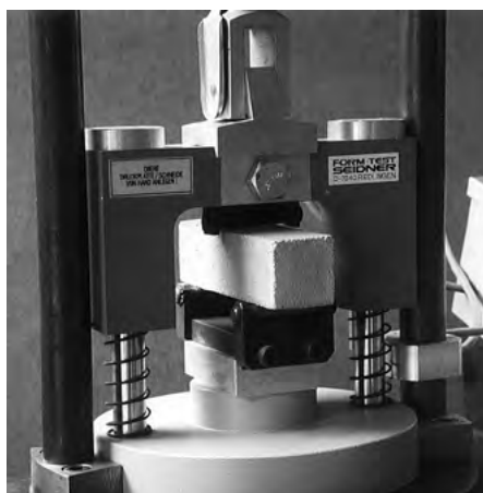
2.6-6 BADANIE WYTRZYMAŁOŚCI NA ROZCIĄGANIE PRZY ZGINANIU
