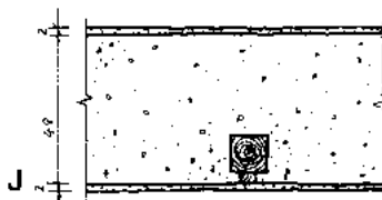
14.2-1 PRZEKROJE POZIOME RÓŻNYCH PRZYKŁADÓW ŚCIAN O WARTOŚCI WSPÓŁCZYNNIKA U = 0,3 \text{ W/m}^2\text{K}
